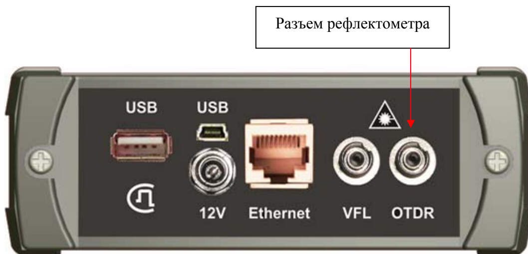
Рис. 69. Подключение оптического волокна к OTDR.
