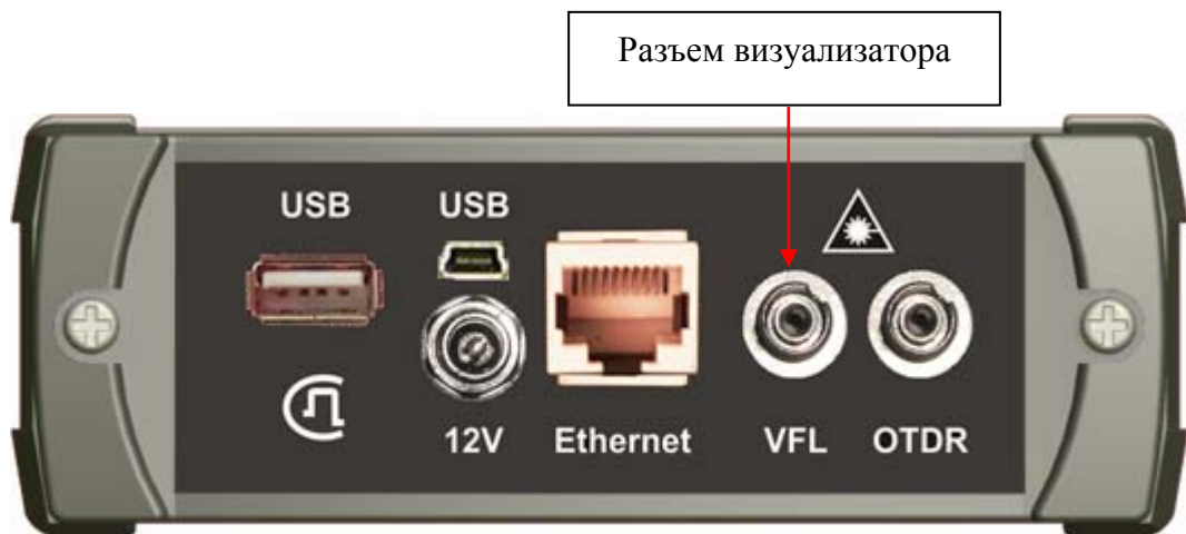
Рис. 66. Подключение ОВ к VFL.
